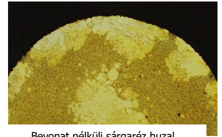
Bevonat nélküli sárgaréz huzal mikroszkóp alatt
